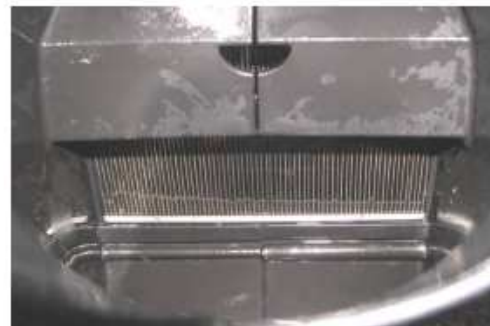
Gereinigde achterzijde van de filter na het gebruik gedurende enkele seconden van een hogedrukreiniger
