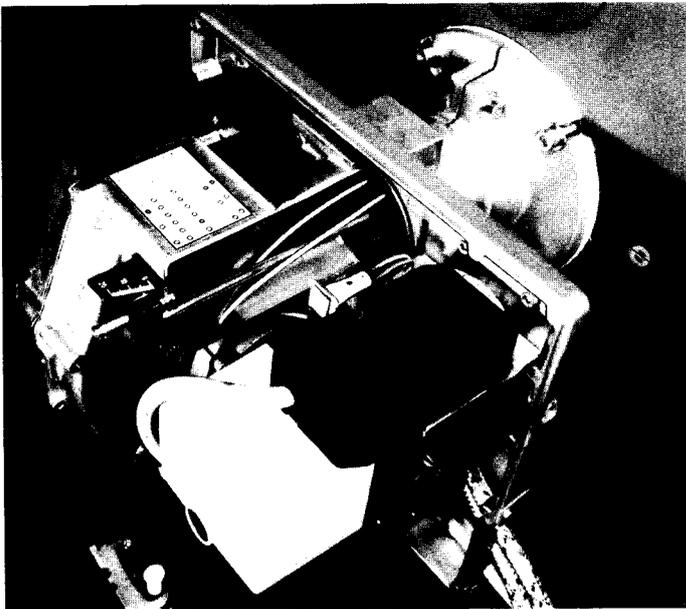
Düsenstockdeckel abgenommen zum Ausbau des Düsenstocks.
